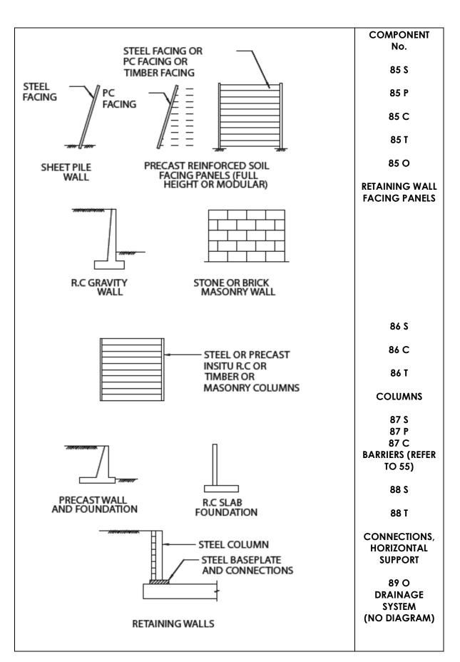
**FIG 24 - RETAINING WALLS**
