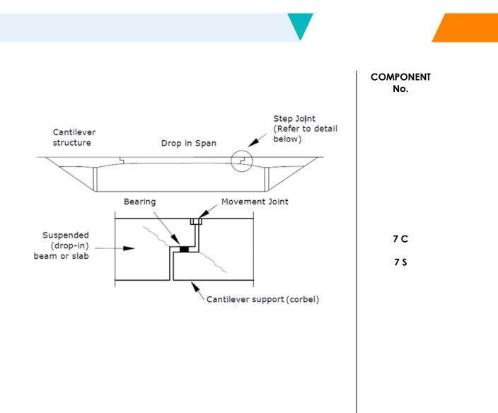
**FIG 5.1 - STEP JOINT**
